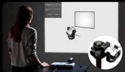
**投影機色彩配置** - 設備定位時，旋轉周圍光源散光器臂充當檯面支架，或在較大場地使用內置螺紋三腳架。
