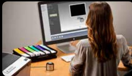
**周圍光源測量** - 集成的周圍光源測量散光器可讓您測量工作環境中的周圍光源測量值。
